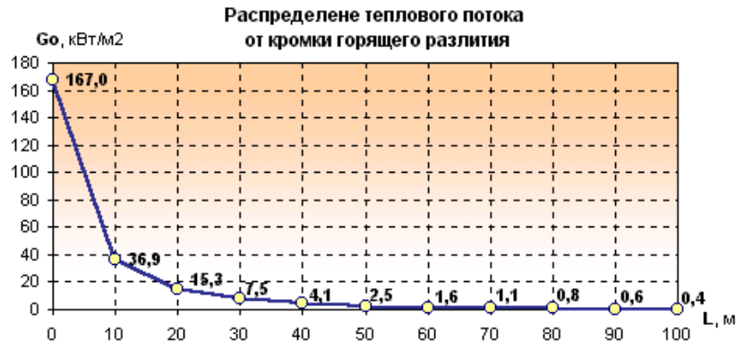
Рисунок 4.2 - Величина теплового потока от кромки горящего разлива СУГ
