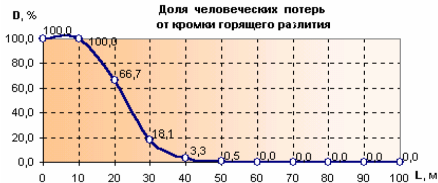
Рисунок 4.3 - Доля человеческих потерь от кромки горящего разлива СУГ.
